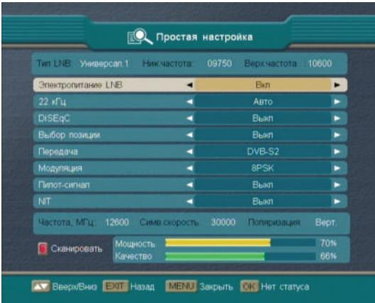
**Электропитание LNB:** Если Ваш приемник подключен непосредственно к спутниковому конвертору LNB, выберите кнопками **◀▶** режим ВКЛ или ВыКЛ. Значение по умолчанию — ВКЛ.
